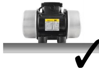
2. Die Montage kann mit Befestigungsschrauben der Festigkeitsklasse 8.8 (DIN 931 oder 933) erfolgen. Diese müssen mit geeigneten Sicherungsmitteln gesichert und in regelmäßigen Intervallen (i. d. R. monatlich) überprüft bzw. nachgezogen werden. **NetterVibration** empfiehlt die Verwendung von NBS-Befestigungssätzen bestehend aus Schraube, spezieller Sicherungsscheibe und (bei NBS D) Mutter zur sicheren Befestigung.
